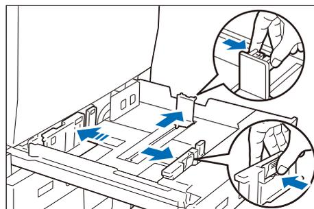
5. 用紙をさばき、印字面を下にして、用紙を矢印の方向にそろえてセットします。
