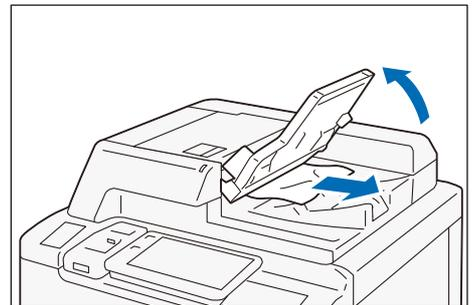
10. 原稿カバーを開き、レバーを引き下げて、裏面読み取り部を開き、原稿を取り除きます。
