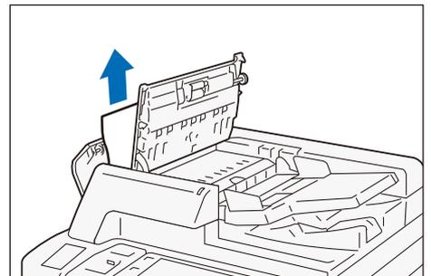
6. 排出口に原稿があるときは、原稿送りトレイを持ち上げ、排出方向に引き抜いてください。
