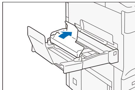
**2. 用紙の印刷面を下にして、用紙受けの下を通し軽く奥に突き当たるまで差し込みます。**
