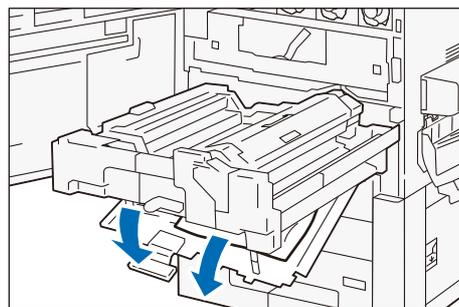
5. 転写ユニットを完全に奥まで押し込み、レバー [2] を左方向に回します。
